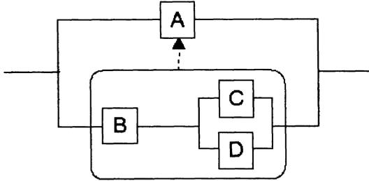
Les états de marche sont :  $1 = A(BCD)_a$ ,  $2 = \bar{A}BCD$ ,  $3 = \bar{A}BC\bar{D}$ ,  $4 = \bar{A}B\bar{C}D$ , les états de panne :  $5 = \bar{A}\bar{B}CD$ ,  $6 = \bar{A}\bar{B}C\bar{D}$ ,  $7 = \bar{A}\bar{B}\bar{C}D$ ,  $8 = \bar{A}\bar{B}\bar{C}D$ .
